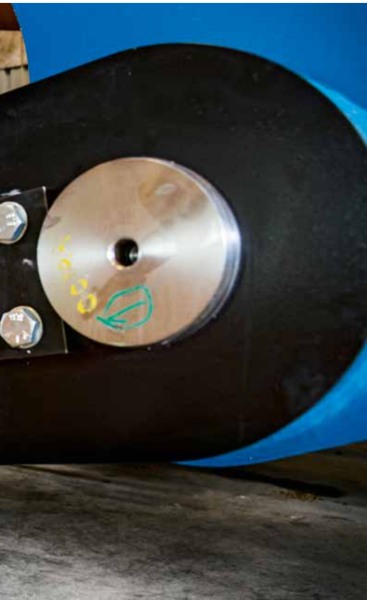
En af de hydrauliske kraftcylindere i testbænken som udøver de mekaniske påvirkninger af testrørene.
