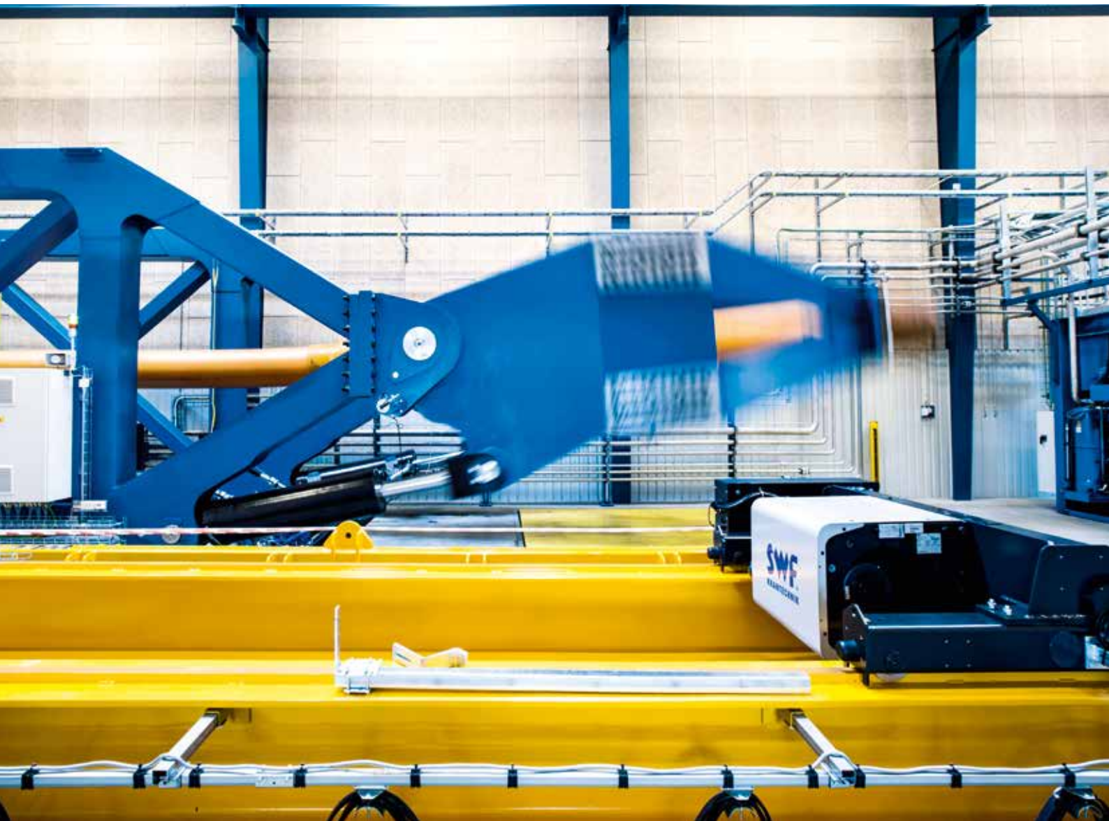
Testbænken kan simulere alle de fysiske belastninger, som røret vil blive udsat for, når det hænger mellem FPSO'en og brønden på havbunden. Skibet vipper på bølgerne i alle slags vejrlig – fra vindstille til orkan – og belaster røret på forskellig vis.
