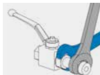
Gegenhalten der Kugelhahn-Verschraubung bei Montage!
