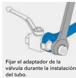
No soldar, taladrar u otro tipo de modificación sobre la válvula.
